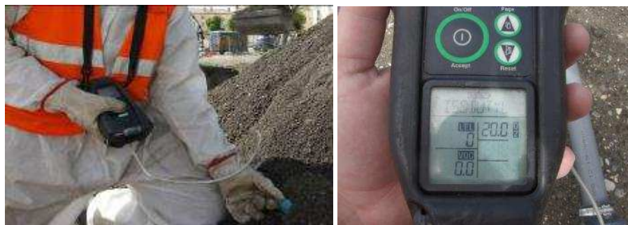
Figure 5 : PID multigaz porté par un technicien environnement
